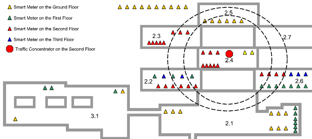
Rys. 18. Lokalizacja liczników pomiarowych w budynku uniwersyteckim [O3].
